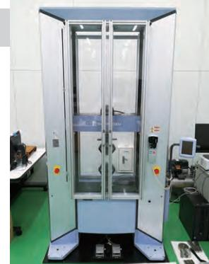
高精度引張・圧縮・曲げ試験機
