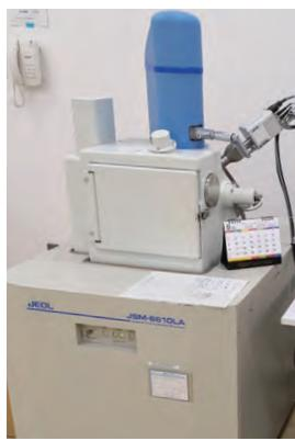
走査電子顕微鏡+X線元素分析装置
