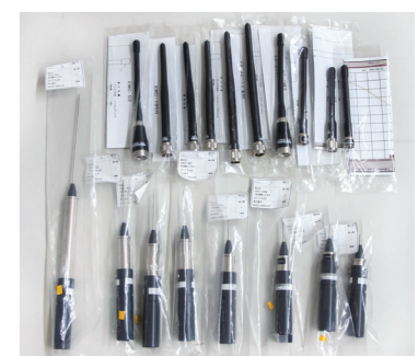
近接アンテナ試験用アンテナ
