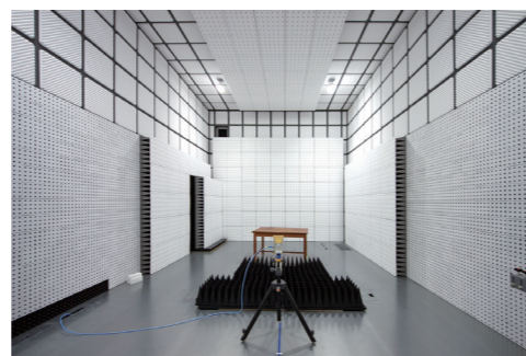
3m法電波暗室
