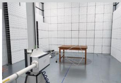
3m法電波暗室
